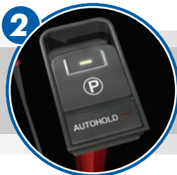
2 Interruptor de parking bloquea y desbloquea a voluntad el freno, ubicado en el tablero principal o consola central.
