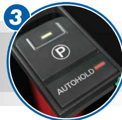
3 Interruptor AutoHold: activa las asistencias de seguridad.
