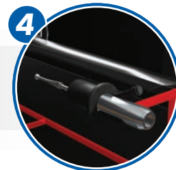
4 Captador de posición de pedal de embrague: informa el punto de salida del pedal del embrague, (no aplica en caja automática).
